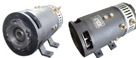
QZD2411 24V 1.1KW 2160RPM BI-DIRECTIONAL/双向 127MM
